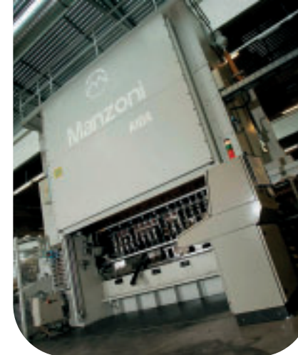
290 Tonnen Umformpresse mit 20 Stationen
