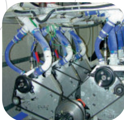
Versuchsaufbau 6-fach Prüfstand bei - 40 °C
