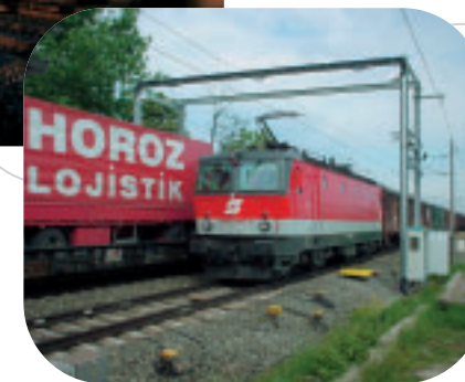
Testzug während einer Testfahrt durch die Lichtraumprofilüberwachungsanlage des Checkpoints
