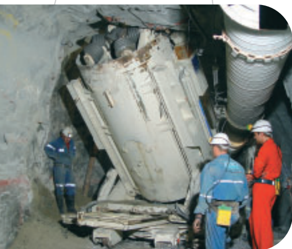
Der Prototyp des VAB Boxhole Drilling Systems ABH 1600 im untertägigen Einsatz
