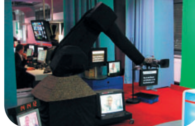
RoboCAM – Roboter dienen in unterschiedlichen Typen zur präzisen motorisierten Bewegung von Studiokameras
