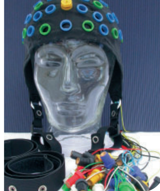
Konventionelle Ableitung der Gehirnaktivität mittels Oberflächen-Elektroden
