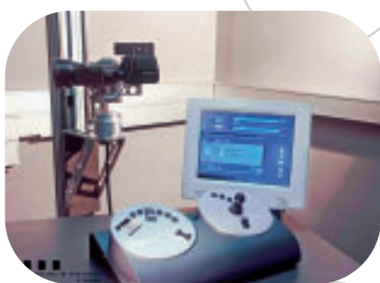
Die Steuereinheit dient zur Echtzeitsteuerung des gesamten Kamerasystems
