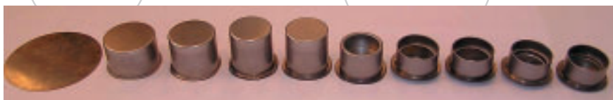
Teile des Stadienganges der Umformung
