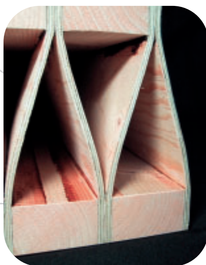
Der Querschnitt des Hohlkammersystems
