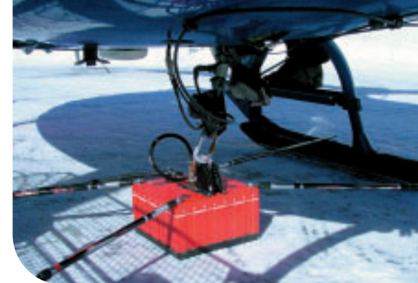
Anbringung des Radargeräts am Helikopter
