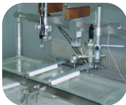
Nanofilmwaage zur molekularen Charakterisierung von Oberflächen
