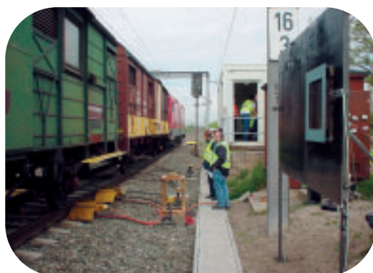
Checkpoint System Tests während einer Testfahrtenserie mit einem präparierten Testzug an der Prototypanlage entlang der Strecke Wien – Budapest bei Himberg
