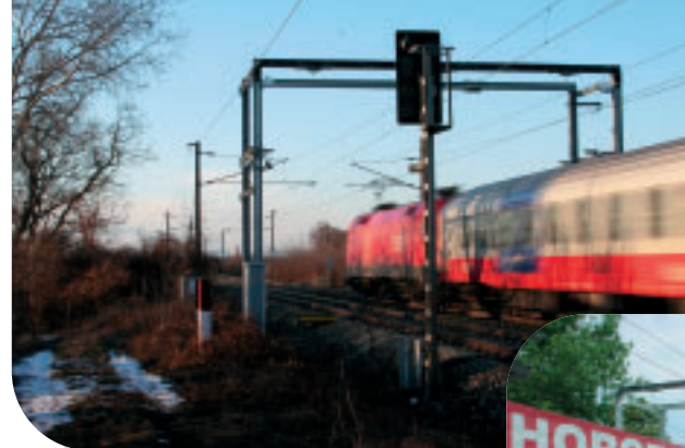
Testzug während einer Testfahrt durch die Lichtraumprofilüberwachungsanlage des Checkpoints
