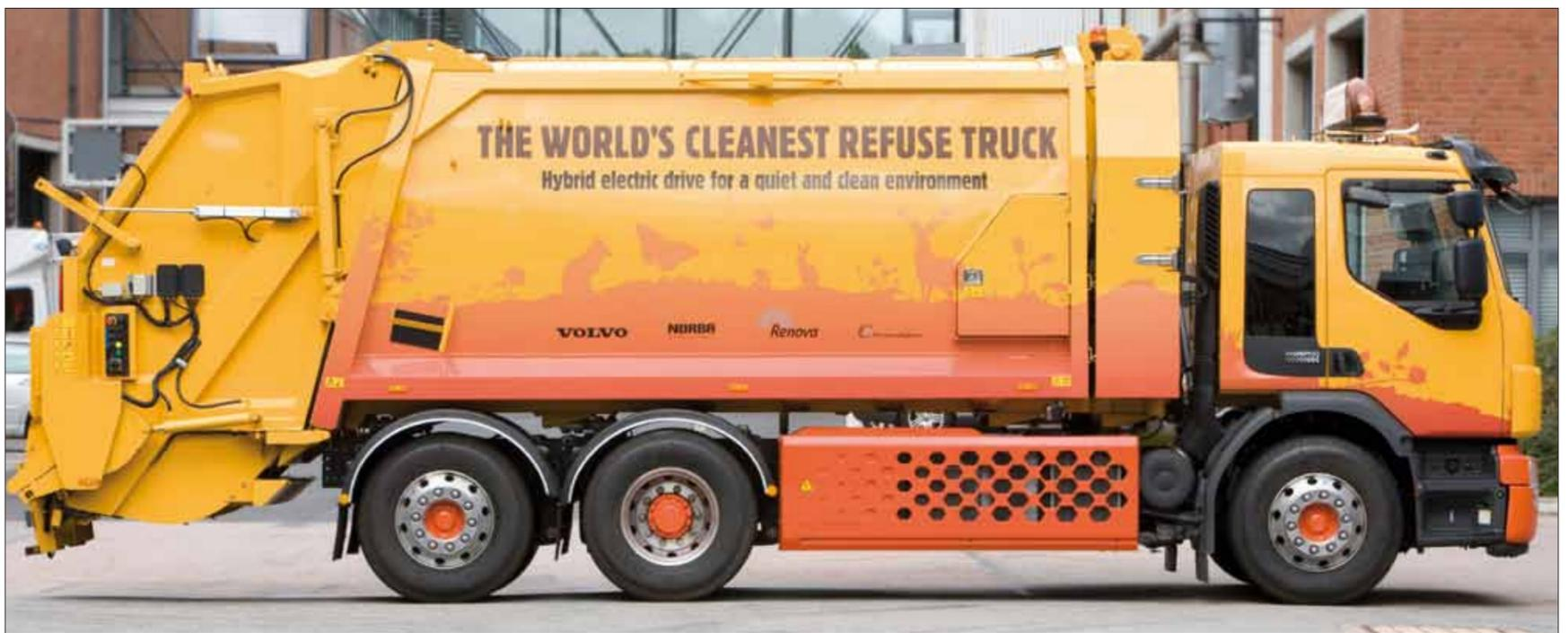
Der Volvo Hybrid-Lkw wird von einem 7-Liter-Dieselmotor angetrieben, der bei den Entsorgungsfahrzeugen 340 PS leistet und ein maximales Drehmoment von 1300 Nm entwickelt. Bei den Fahrzeugen für den Verteilerverkehr leistet er 300 PS bei 1160 Nm. Der Dieselmotor arbeitet parallel mit einem 120 kW leistenden Elektromotor. Der Elektromotor bezieht seine Energie aus Lithium-Ionen-Batterien der neuesten Generation.
